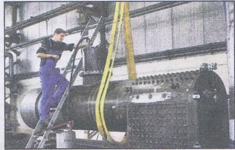
*Der neue Dampfkessel wird momentan einer Druckprüfung unterzogen.*
